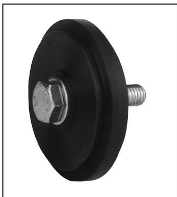
Il kit è composto da una rotella folle sul perno. La rotella è in polietilene ad alta densità molecolare. Velocità di lavoro  $\leq 30\text{m/min}$ .
