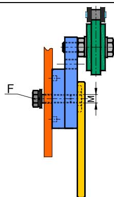
2) Mantenendo la vite di fissaggio F lenta, con l'aiuto di una chiave inglese caricare il tenditore fino all'angolo di rotazione desiderato. Successivamente stringere la vite di fissaggio F. / Keeping the slow fixing screw F, with the help of a spanner load the tightener until the desired rotation angle. Tighten then the fixing screw F.
