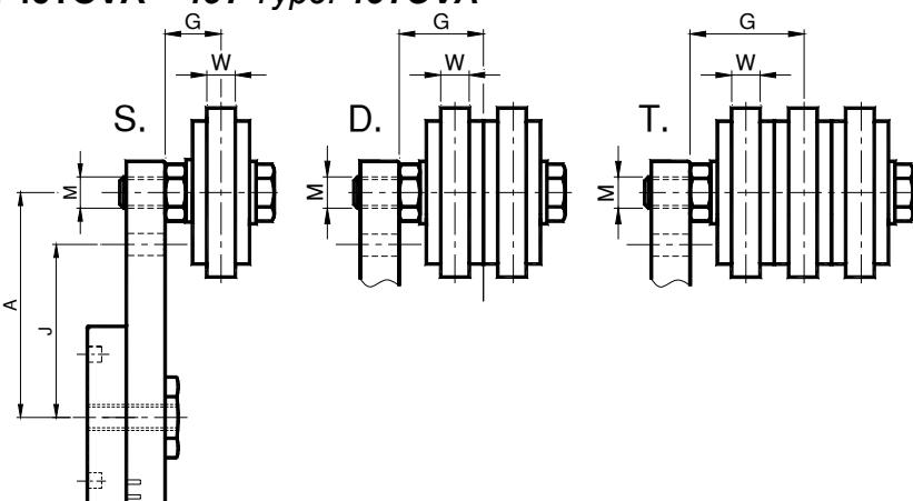
Il tenditore 45TOVA è composto dall'elemento 45T e dal kit per tendicatena OVA. I valori di carico sono riportati a pag 06. Specificare nell'ordine il montaggio del kit sul foro A o J. In mancanza di specifiche richieste sarà fornito posizionato sul foro A.
