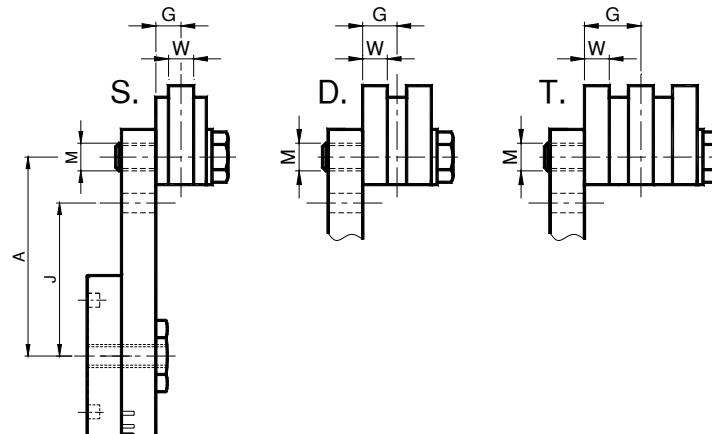
Il tenditore 45TVB è composto dall'elemento 45T e dal kit per tendicatena VB. I valori di carico sono riportati a pag 06. Specificare nell'ordine il montaggio del kit sul foro A o J. In mancanza di specifiche richieste sarà fornito posizionato sul foro A.
