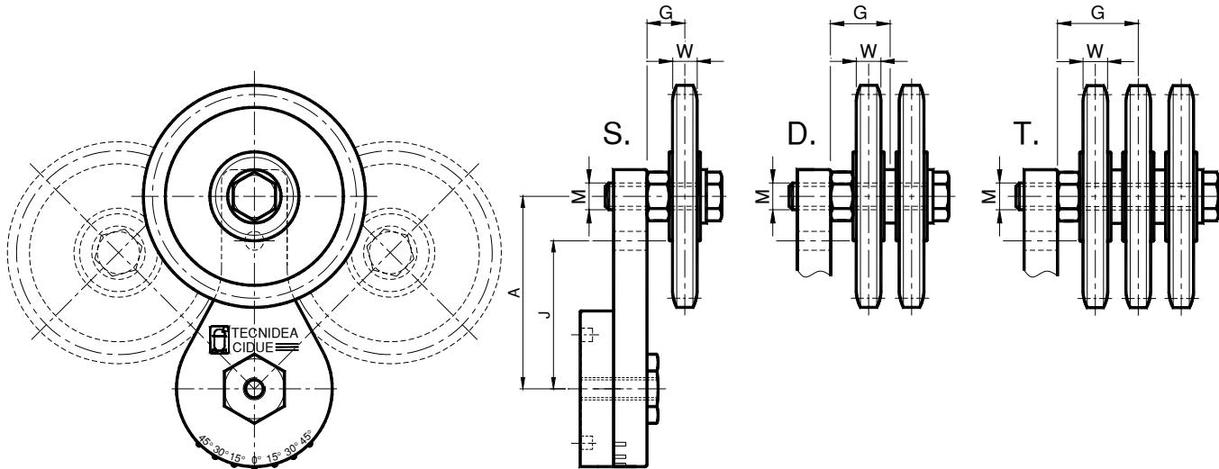
Il tenditore 45TKB è composto dall'elemento 45T e dal kit per tendicatena KB. I valori di carico sono riportati a pag 06. Specificare nell'ordine il montaggio del kit sul foro A o J. In mancanza di specifiche richieste sarà fornito posizionato sul foro A.
