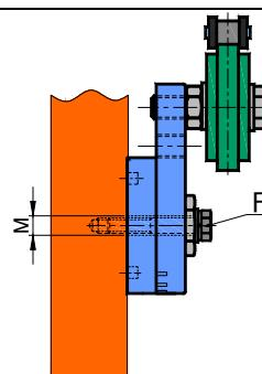
4) Per un montaggio frontale (ad esempio su piastre "cieche") si possono seguire le istruzioni 1 e 2, ma utilizzando una vite di fissaggio F con dimensione minore del foro filettato M della boccola centrale.
