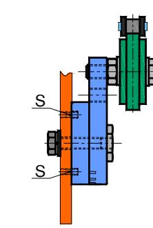
3) Dopo il fissaggio della vite M, Per evitare eventuali slittamenti, si può inserire una spina di reazione in una delle nicchie di alloggiamento S. / After the fixing of the M screw, in order to avoid possible slippings, one reaction pin may be inserted in the S slot niches.
