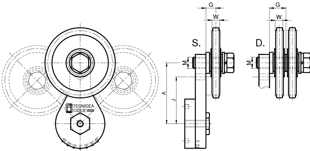
Il tenditore 45TIB è composto dall'elemento 45T e dal kit per tendicatena IB. I valori di carico sono riportati a pag 06. Specificare nell'ordine il montaggio del kit sul foro A o J. In mancanza di specifiche richieste sarà fornito posizionato sul foro A.
