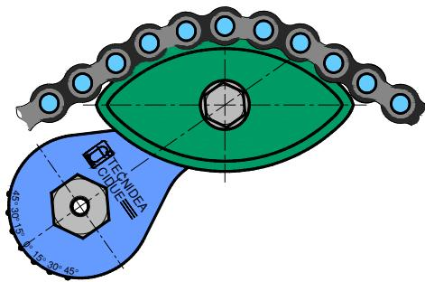
Il pattino OVA consente un'elevata durata di funzionamento in quanto oltre a consentire l'appoggio su più rulli della catena, quindi minor usura, permette di utilizzare un secondo profilo di scorrimento ruotando il pattino.
