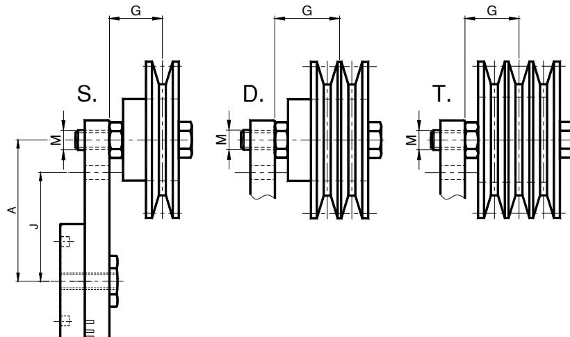
Il tenditore 45TPQ è composto dall'elemento base 45T e dal kit per tendicinghia PQ. I valori di carico sono riportati a pag 06. Specificare nell'ordine il montaggio del kit sul foro A o J. In mancanza di specifiche richieste sarà fornito posizionato sul foro A.
