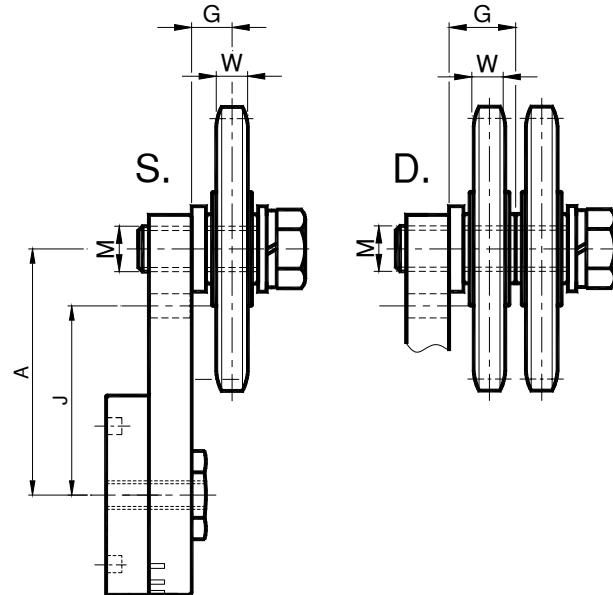
Il tenditore 45TNB è composto dall'elemento 45T e dal kit per tendicatena NB. I valori di carico sono riportati a pag 06. Specificare nell'ordine il montaggio del kit sul foro A o J. In mancanza di specifiche richieste sarà fornito posizionato sul foro A.
