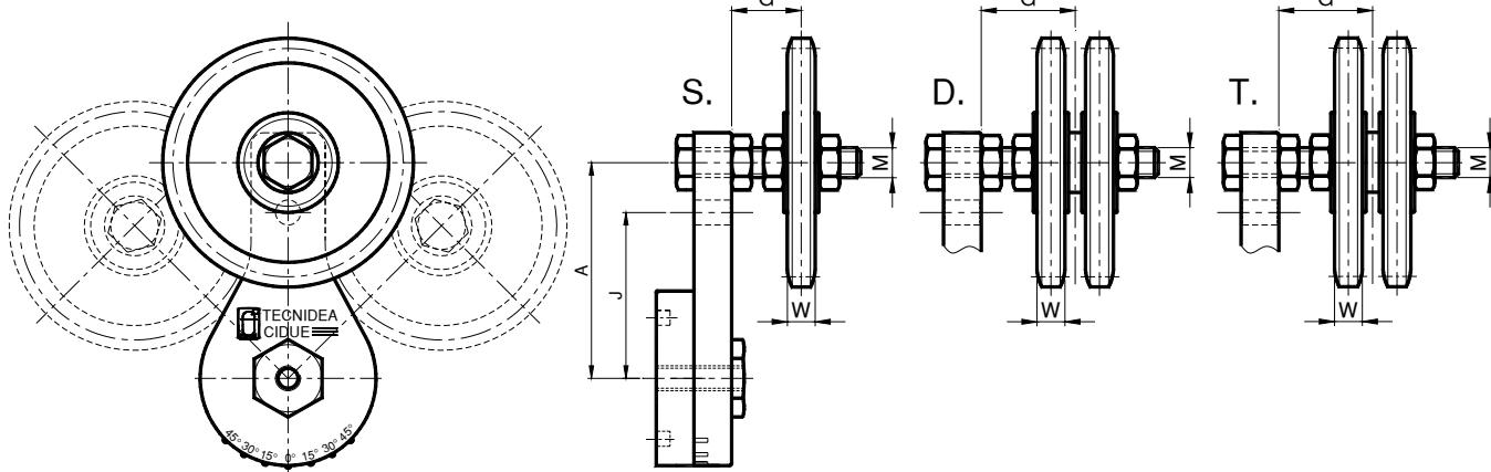
Il tenditore 45TZK è composto dall'elemento 45T e dal kit per tendicatena ZK. I valori di carico sono riportati a pag 06. Specificare nell'ordine il montaggio del kit sul foro A o J. In mancanza di specifiche richieste sarà fornito posizionato sul foro A.
