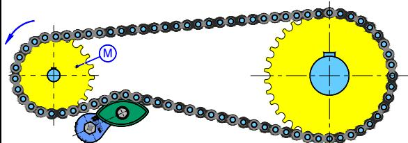
Fig. 1 Montaggio corretto con azionamento dall'esterno.
