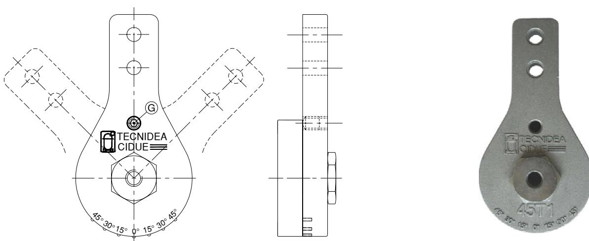
■ **IMPIEGO** Il sistema di precarica USO **PG** permette agendo sul grano G di bloccare l'elemento elastico all'angolo di rotazione desiderato. Dopo l'installazione il grano G va allentato per poter far lavorare l'elemento elastico.
