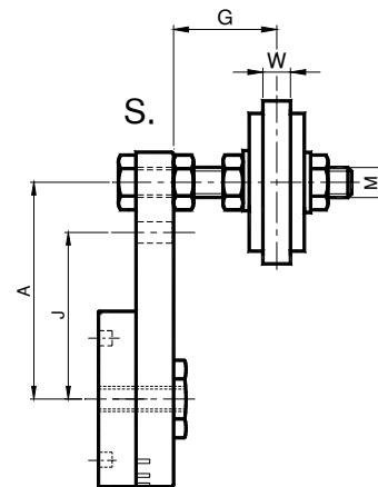
Il tenditore 45TOVR è composto dall'elemento 45T e dal kit per tendicatena OVR. I valori di carico sono riportati a pag 06. Specificare nell'ordine il montaggio del kit sul foro A o J. In mancanza di specifiche richieste sarà fornito posizionato sul foro A.
