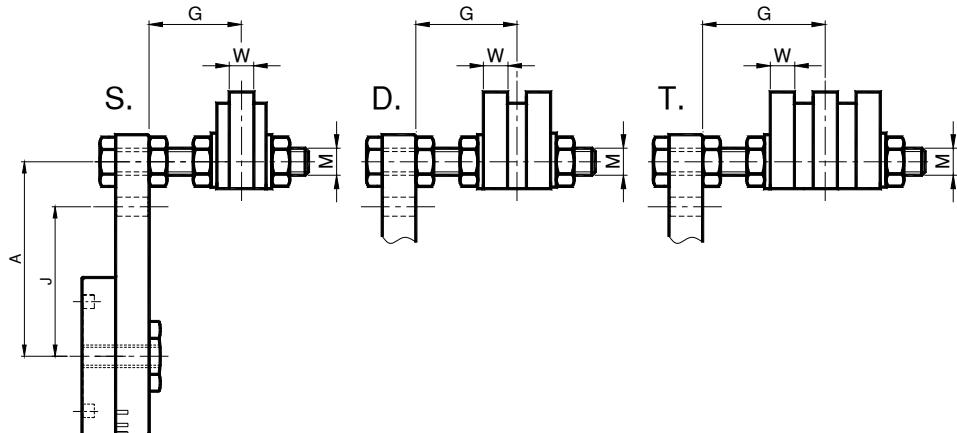
Il tenditore 45TVR è composto dall'elemento 45T e dal kit per tendicatena VR. I valori di carico sono riportati a pag 06. Specificare nell'ordine il montaggio del kit sul foro A o J. In mancanza di specifiche richieste sarà fornito posizionato sul foro A.
