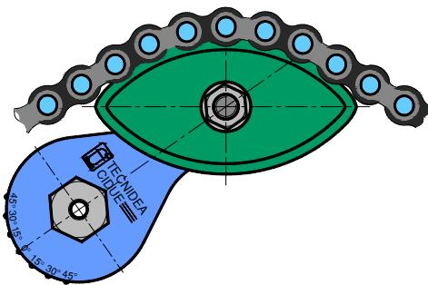
Il pattino OVR consente un'elevata durata di funzionamento in quanto oltre a consentire l'appoggio su più rulli della catena, quindi minor usura, permette di utilizzare un secondo profilo di scorrimento ruotando il pattino.
