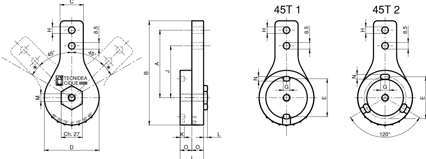
\* = 45T 1: Angolo di rotazione max:  $\pm 60^\circ$  / 45T 1: Maximum rotational angle:  $\pm 60^\circ$
