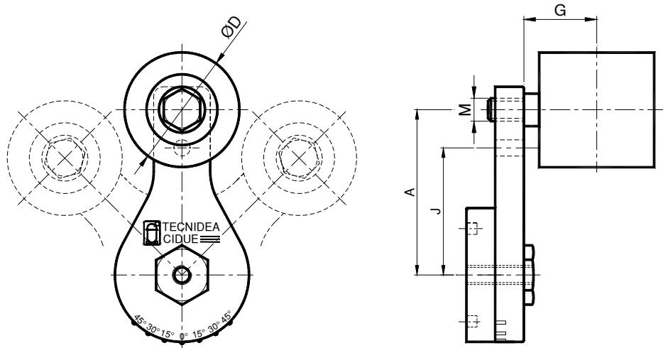
Il tenditore 45TRP è composto dall'elemento 45T e dal kit per tendicinghia RP. I valori di carico sono riportati a pag 06. Specificare nell'ordine il montaggio del kit sul foro A o J. In mancanza di specifiche richieste sarà fornito posizionato sul foro A.
